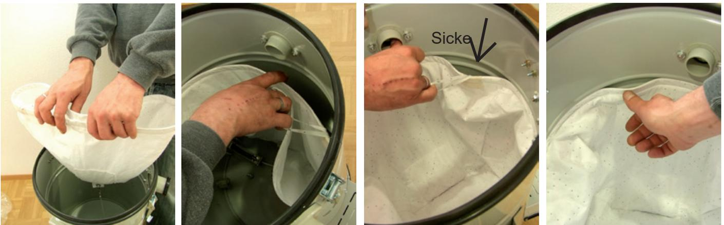
Bevor Sie den neuen Filter einsetzen ist der Haken als Erstes wieder zu befestigen. Beim Einsetzen des neuen Filters muss der Federspannung zu einem Halbkreis geformt werden und in die Sicke eingelegt werden.
