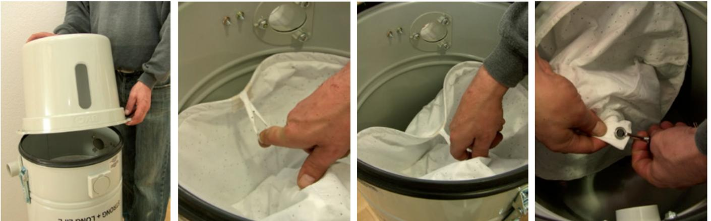
Der Federspannung muss an der Lasche zur Mitte hin angezogen werden. Hierdurch verformt sich der Filter, was zum Entfernen notwendig ist. Anschließend ist der Haken der Filterrüttlerschnur zu lösen.
